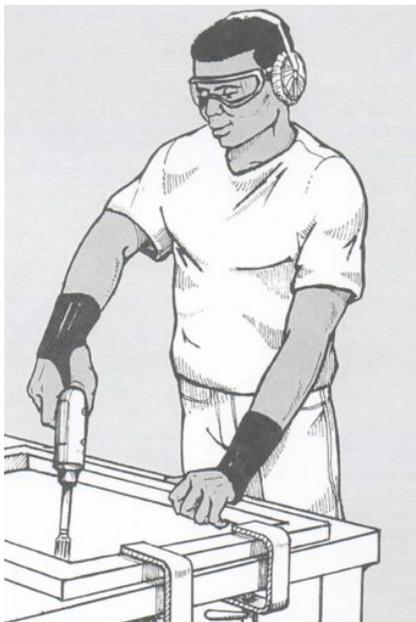
Figure 27 : Coquille de protection sur les poignets
